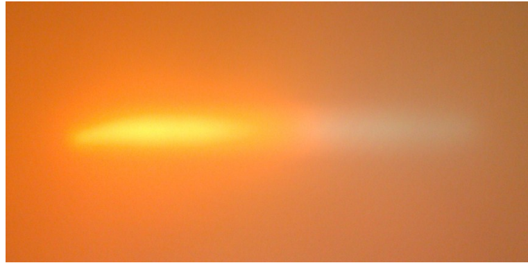
Figura 2 - Lâmpada com ocorrência de cataforese.
