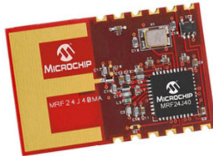
Figura 1.1 - Transceptor RF compatível com o padrão IEEE 802.15.4 TM . Modelo: MRF24J40MA, fabricante: Microchip Inc.
