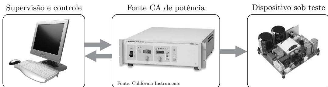
Figura 1: Aplicação de fontes CA de potência.
