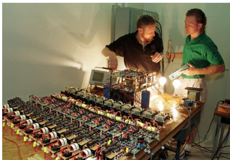
Figura 17 – Montagem de 12 módulos para um SST de 10 kVA. Fonte: (RONAN et al. , 2002)
