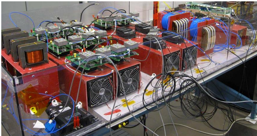
Figura 14 – Foto do protótipo do SST FREEDM. Fonte: (WANG, G. et al. , 2011)
