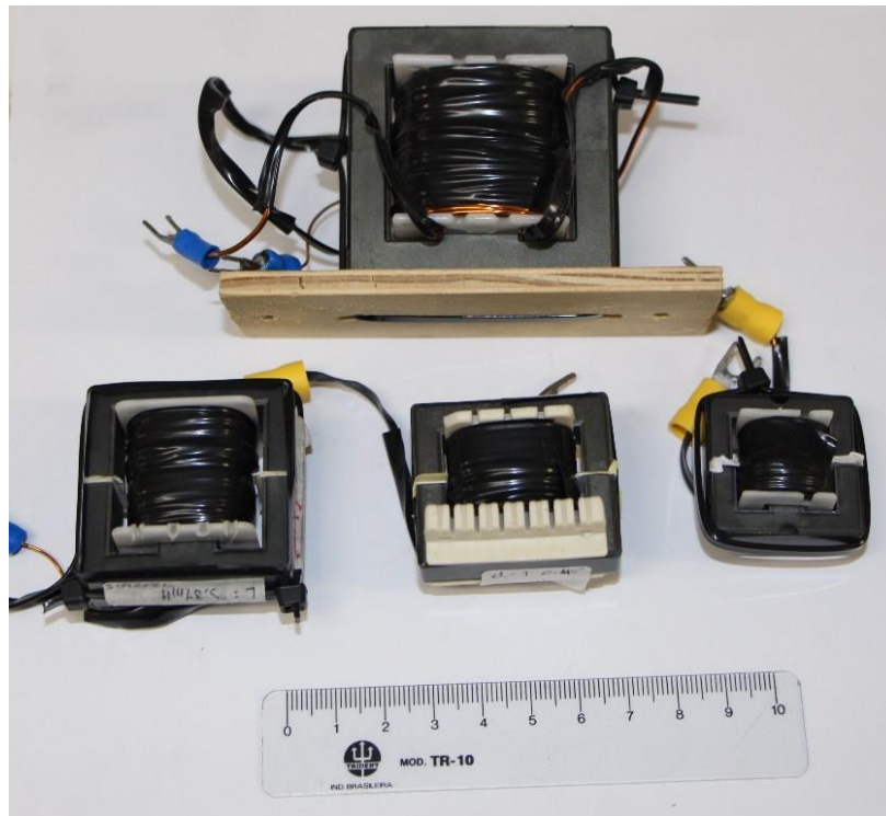
Figura 37 – Fotografia dos indutores auxiliares (75°, 45° e 15°, abaixo, da esquerda para direita) e do transformador (acima) desenvolvidos
