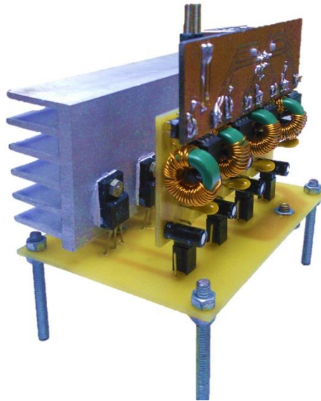
Figura 128 – Placa de potência juntamente com os quatro drivers
