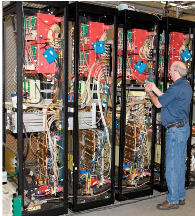
Figura 16 – Protótipo de um SST de 1 MVA. Fonte: (DAS et al. , 2011)
