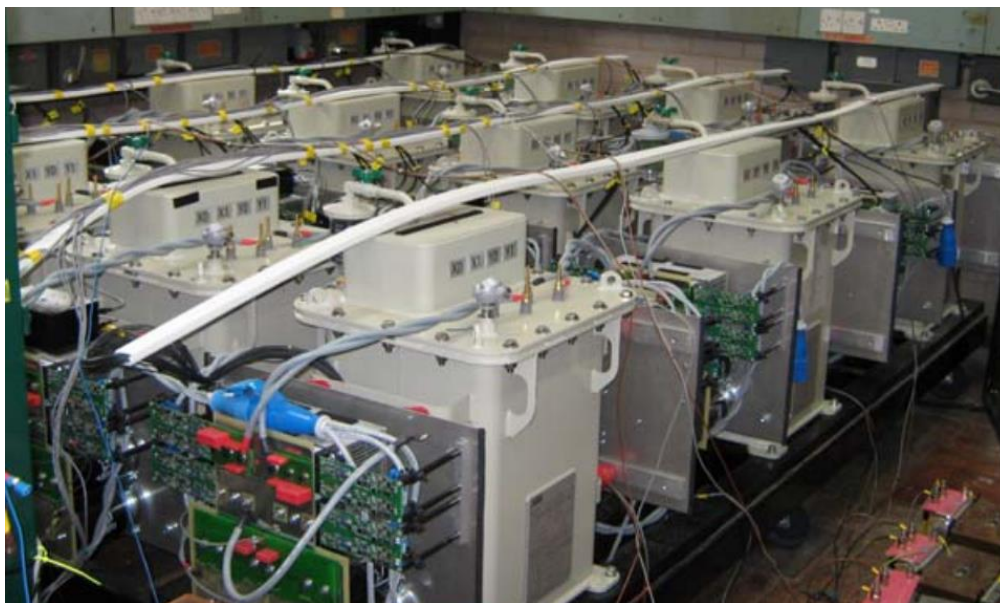
Figura 15 – Protótipo do projeto UNIFLEX. Fonte: (BIFARETTI et al. , 2011)
