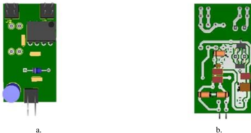
Figura 121 – Layout em 3D do protótipo da placa de driver com uma saída: a. Visão superior; b. Visão inferior
