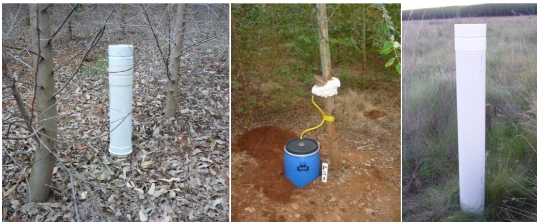
Figura 3 – Aspecto de coletores de precipitação utilizados no monitoramento da precipitação em plantio de Eucalyptus dunnii localizado em Alegrete, RS.
