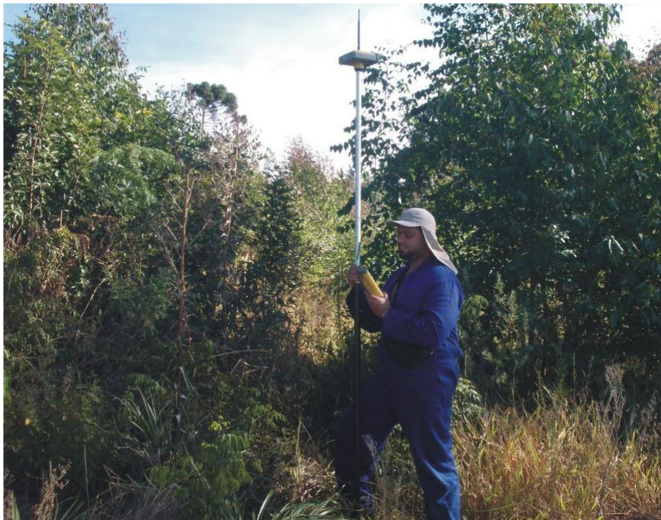
Figura 1 - Coleta de pontos com o receptor do GNSS modelo Hiper/RTK (Base e Rover) da Topcon, operado no modo Semi-cinemático (Stop & Go) no sistema geodésico SIRGAS 2000.
