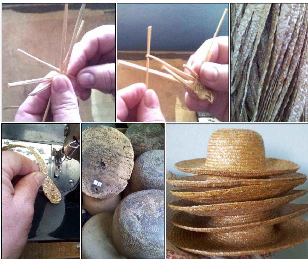
Figura 49 – Etapas da confecção de chapéu de palha de trigo em Silveira Martins
