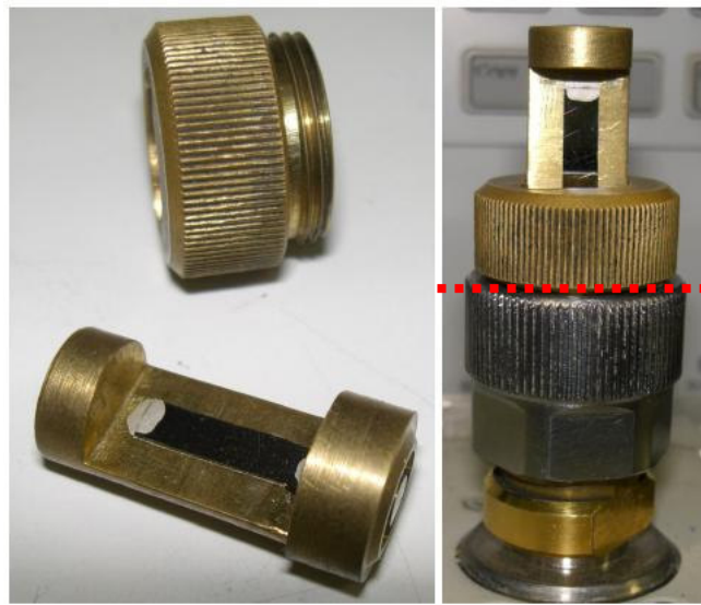
Figura 26: (a) Sistema de medidas de MI, mostrando o conjunto de calibração. Na figura da direita é apresentado o procedimento padrão de aberto, curto e carga para o casamento da impedância do kit com o analisador em 50 \Omega . (b) Cavidade tipo strip line desenvolvida para a medida da impedância. A linha tracejada mostra o plano de referencia para a calibração do equipamento. A partir desta linha, a variação da impedância é consequência da variação da impedância e do porta-amostra.
