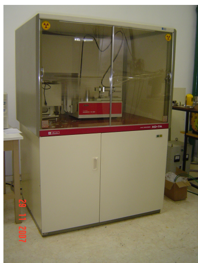
Figura 4.16: Na esquerda, difratômetro Shimadzu, modelo XD-7A, e, em detalhe, na direita, fonte de radiação, detector e goniômetro Shimadzu, modelo VG-208R, com suporte para a amostra.
