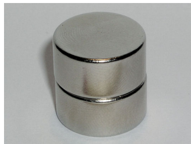
Figura 4.10: Ímãs permanentes de \text{Nd}_2\text{Fe}_{14}\text{B} que compõem o canhão do sistema de deposição de filmes.
