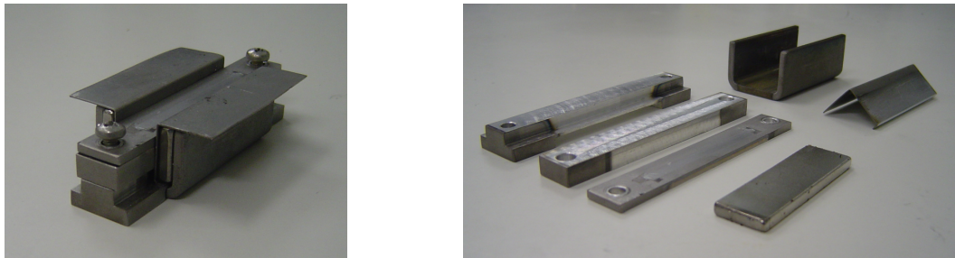
Figura 4.13: Sistema de indução de anisotropia em filmes ferromagnéticos. Na esquerda, dispositivo desenvolvido para aplicação de campo magnético durante a deposição dos filmes e, em detalhe, na direita, peças que compõem o sistema.
