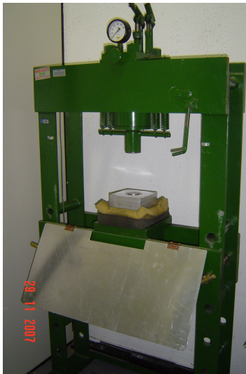
Figura 4.3: Sistema de prensagem, na esquerda, prensa hidráulica e, em detalhe, na direita, “bushing” e cilindros de inox e forma de Cu.
