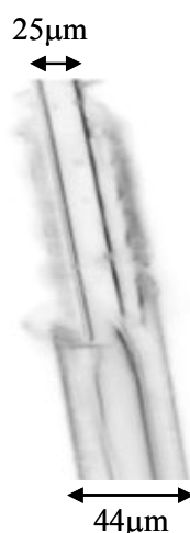
Figura 4-3: Imagem de um microfio amorfo recoberto por vidro, CoFeSiB, com diâmetro total de 44 \mu\text{m} e diâmetro do núcleo metálico igual a 25 \mu\text{m} . Esta é uma imagem da amostra estudada neste trabalho, como feita.
