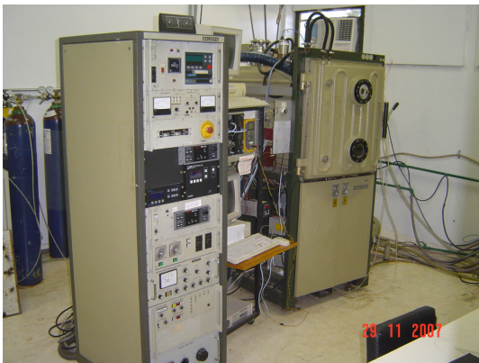
Figura 3.2: Equipamento de “sputtering” do LMMM. Acima: representação esquemática. Esquerda Inferior: fotografia da parte externa. Direita inferior: fotografia do interior da câmara.
