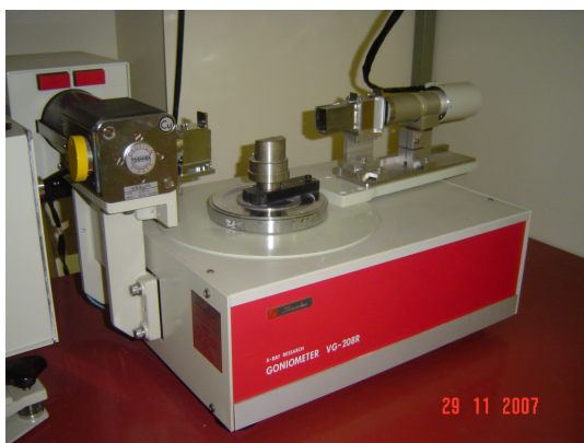
Figura 3.9: Fotos dos goniômetros dos equipamentos usados para as medidas de difração de raios-X: Shimadzu XD7A (esquerda) e Bruker D8 Advance (direita).
