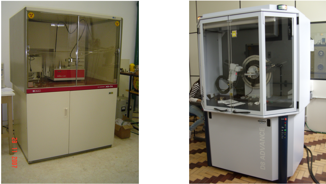
Figura 3.5: Fotos dos equipamentos usados para as medidas de difração de raios-X: Shimadzu XD7A (esquerda) e Bruker D8 Advance (direita).
