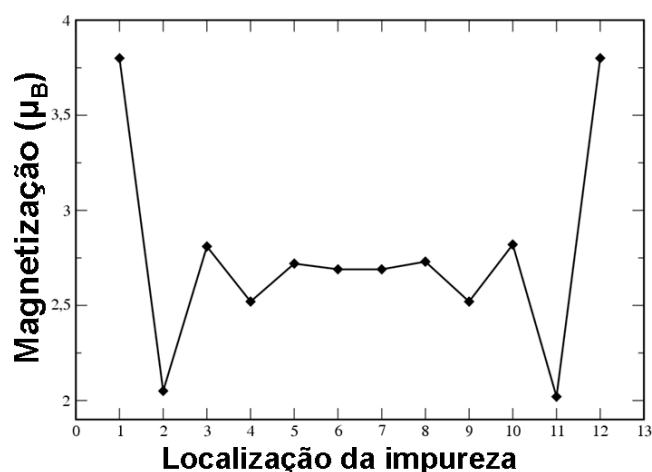
Figura 6.16 – Variação da magnetização para Mn substitucional nas 12 posições distintas na largura da célula unitária.
