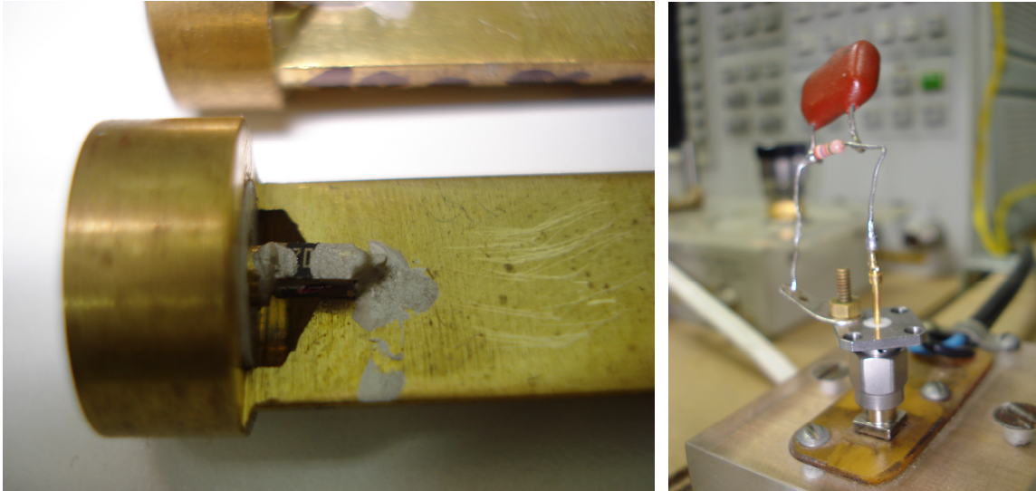
Figura 4.25: A esquerda, um circuito RC colado com tinta prata em uma cavidade de microondas tipo “stripline” com componentes SMD. Na direita um circuito RC com componentes comuns montados em um conector SMA fêmea.
