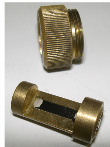
Figura 3.14: Diagrama esquemático do porta-amostras usado nas medidas de impedância e a direita foto de um porta-amostras com uma amostra montada .
