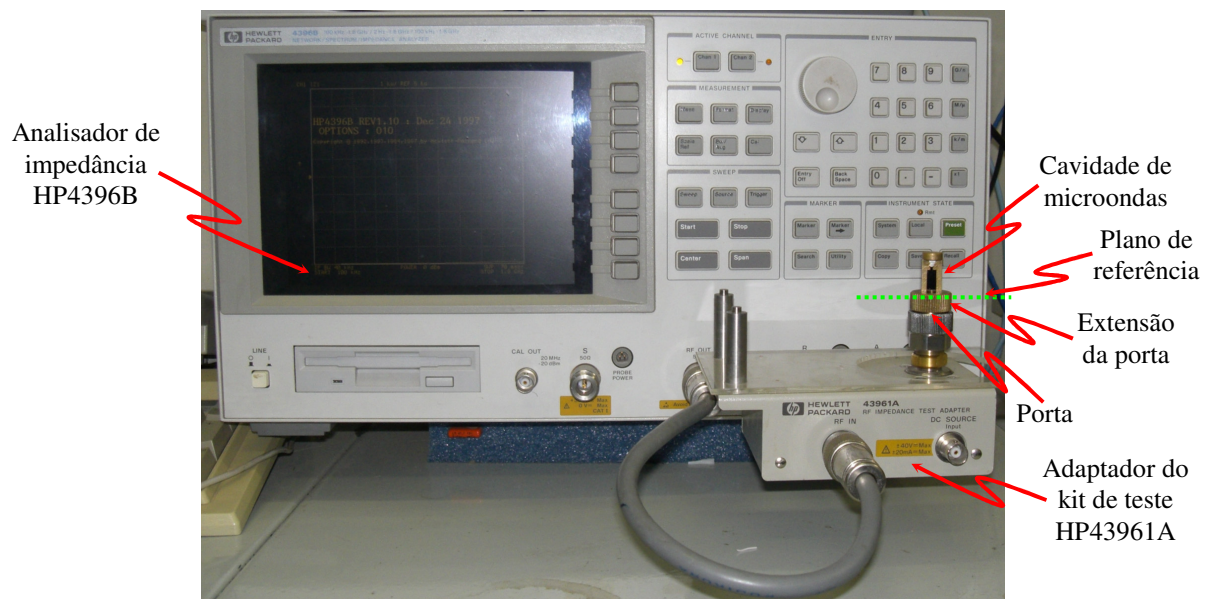
Figura 3-20. Foto de parte do sistema de medidas de MI do LMMM – UFSM.
