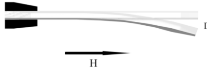
Figura B.5: Esquema representativo da deflexão de um cantiléver formado por um filme magnetostrictivo depositado sobre um substrato. Figurada adaptada de [69].
