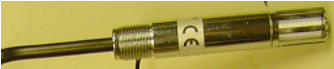
Figura 4.2 – Sensor de temperatura e umidade do ar modelo Humitter 50Y Vaisala Inc. usado na sonda de CO 2 .
