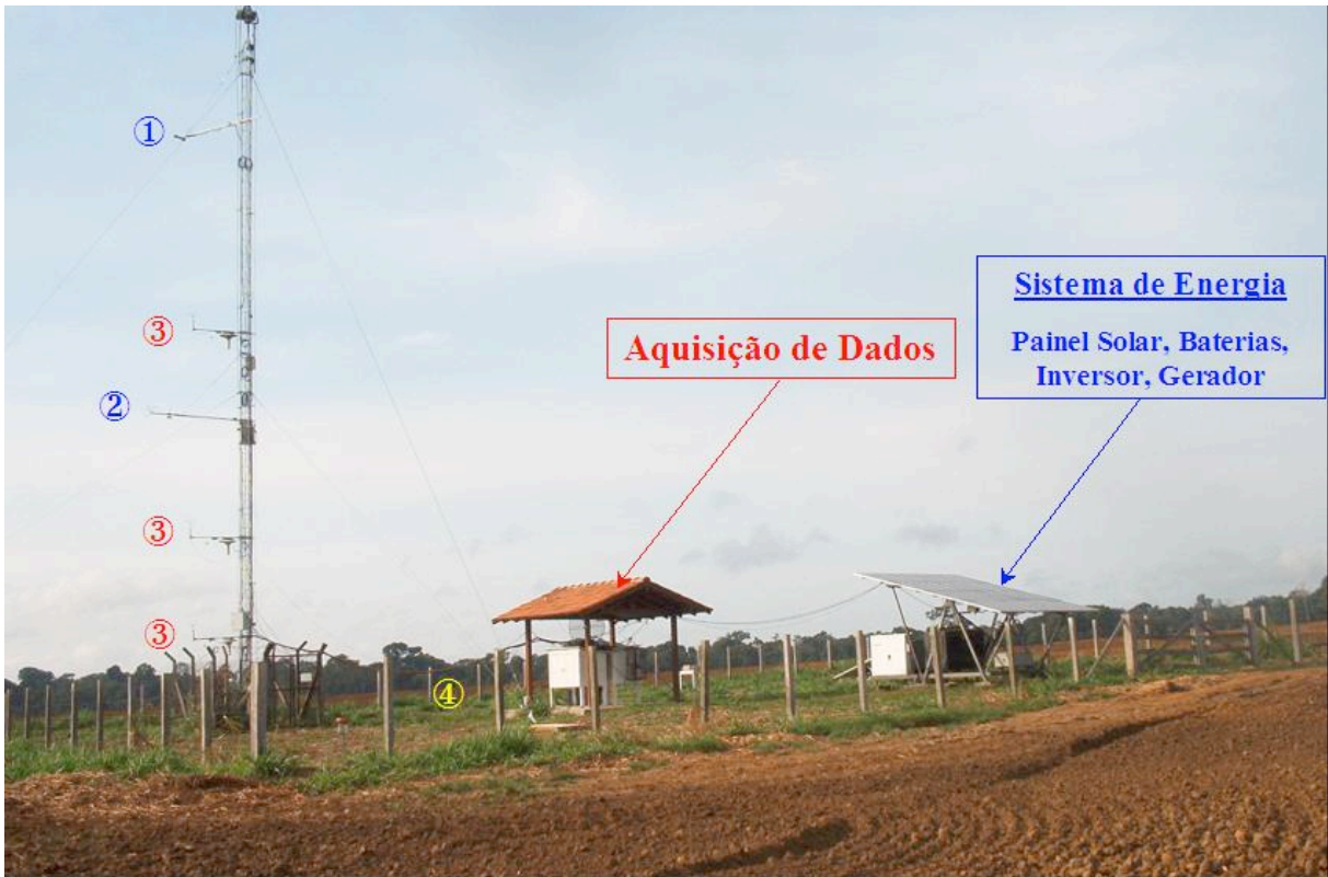
Figura 5.4 – Local da torre no sítio do km77. Os números indicam a posição: (1) Radiômetros; (2) Sistema de Correlação de Vórtices; (3) medidas dos perfis de vento, temperatura, umidade e CO 2 e (4) sensores no solo. Os sistemas de energia e aquisição também são mostrados. Foto em 12/11/2003.
