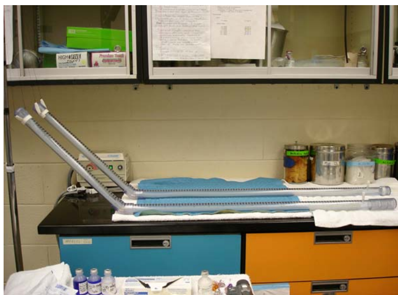
Figura 1 – Duas unidades do modelo experimental subaracnóide de PVC transparente fixados em bancada.
