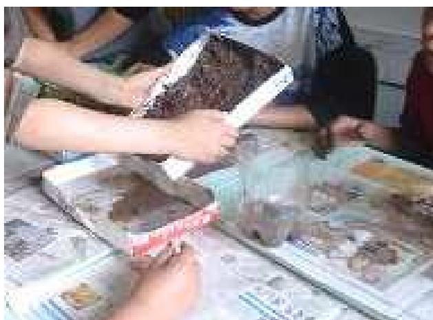
Figura 9– Experimento de erosão fluvial em solo sem proteção vegetal. ( Regina Fuchs – outubro 2007)
