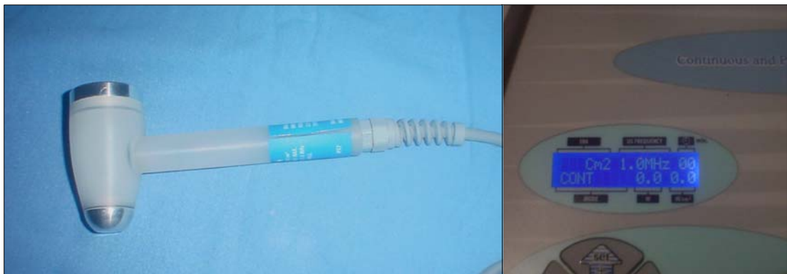
Figura 2 – Detalhe do transdutor com duas áreas efetivas de radiação (ERA), de 1 e 3,5 cm 2 , e do visor de cristal líquido do ultra-som terapêutico.
