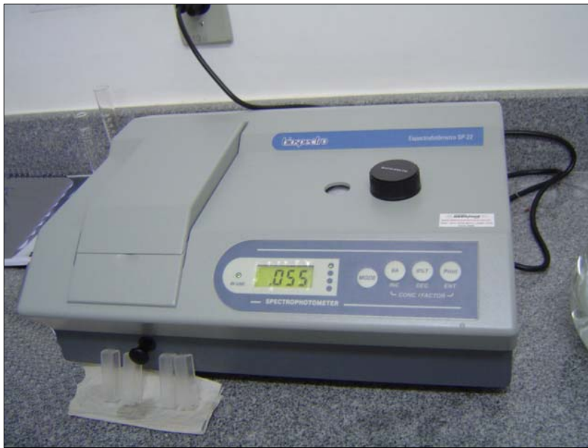
Figura 4 – Espectrofotômetro da marca Bioespectro ® , modelo SP-22, utilizado para a leitura das absorvâncias das amostras de soros.
