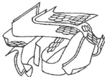
Figura 24. Esquema da estrutura de carvão ativado [Soares, 2001] adaptado de Stoeckli (1990).
