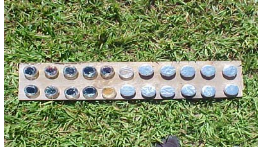
Figura 31. Amostras de bioóleo destilado e não destilado expostas à irradiação (teste de degradabilidade – fotodegradação).
