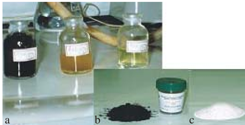
Figura 34. Fotografias dos produtos obtidos da pirólise da casca de arroz (a) líquidos após destilação a vácuo, (b) resíduo sílico-carbonoso antes da calcinação e (c) sílica calcinada a 1050 °C.
