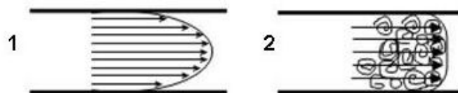
Figura 2. Representação dos fluxos laminar (1) e turbulento (2) em uma coluna cromatográfica
