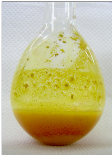
Figura 4. Digerido obtido após o preparo da amostra segundo o Método III da USP 30 para o cloridrato de amitriptilina.
