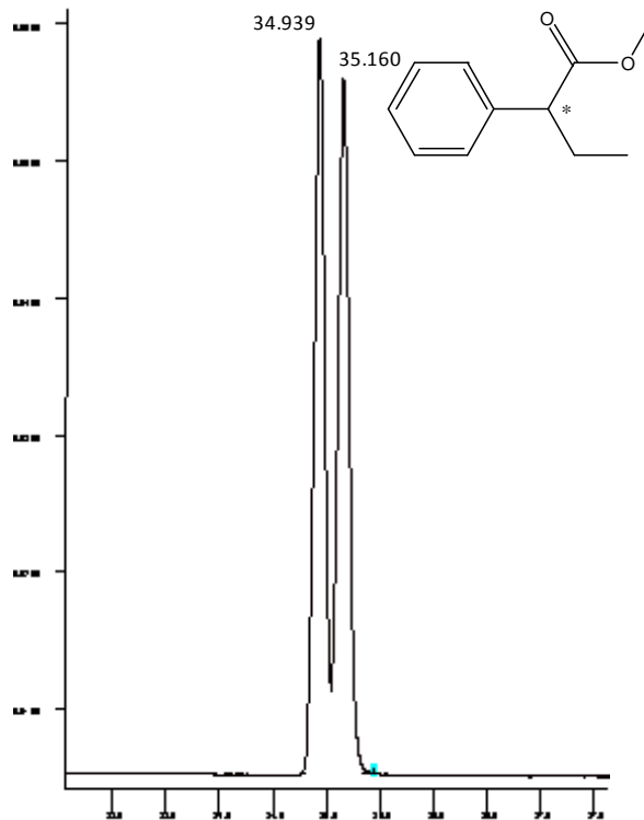
FIGURA 34: Separação enantiomérica de (+/-)-ácido 2-fenilbutírico em CCSF de 25 m recoberta com 2,6-Pe-3-PFP- \beta -CD/ OV 1701 (1:1). 7 psi de H 2 , 30 °C \rightarrow 180 °C (2°/min).
