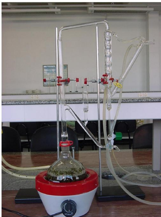
Figura 18. Aparelho de Clevenger modificado, utilizado na extração dos óleos essenciais.
