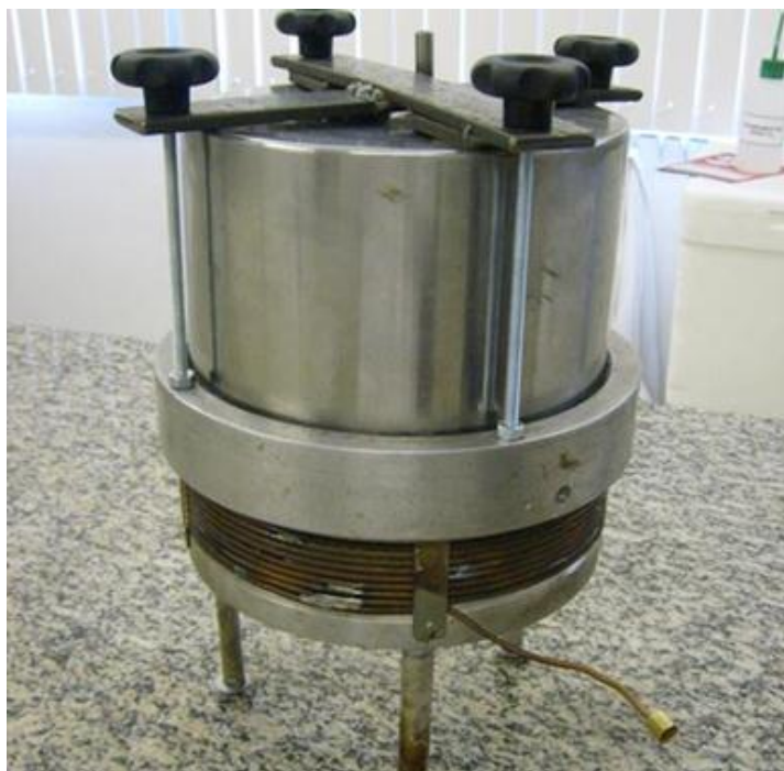
Figura 30: Vista da montagem da serpentina de cobre para aquecimento e condução do gás argônio no DEC.
