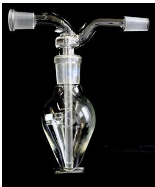
Figura 22: Frasco lavador de gases (trap) utilizado na coleta dos fumos.
