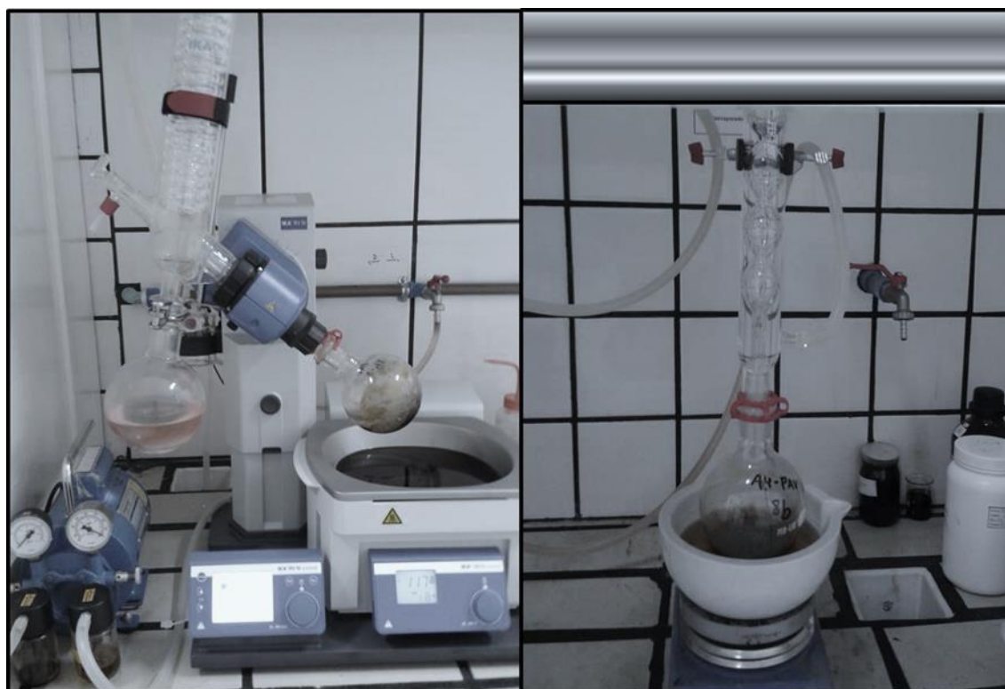
Figura 23: Foto do rotaevaporador e sistema de refluxo em óleo.
