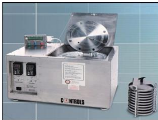
Figura 19: Equipamento utilizado para o ensaio de envelhecimento a longo prazo (PAV).
