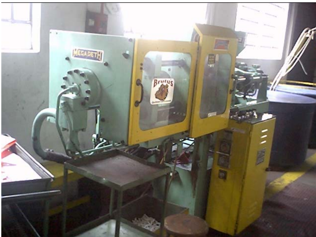
Figura 32 – Máquina de alta tecnologia utilizada na injeção de cabos plásticos.
