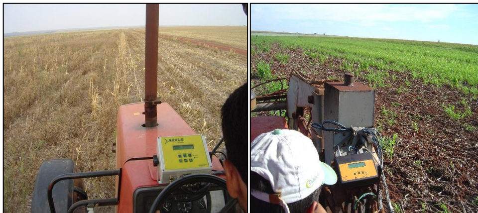
Figura 18 – Controlador eletrônico de aplicação de insumos a taxa variável.
