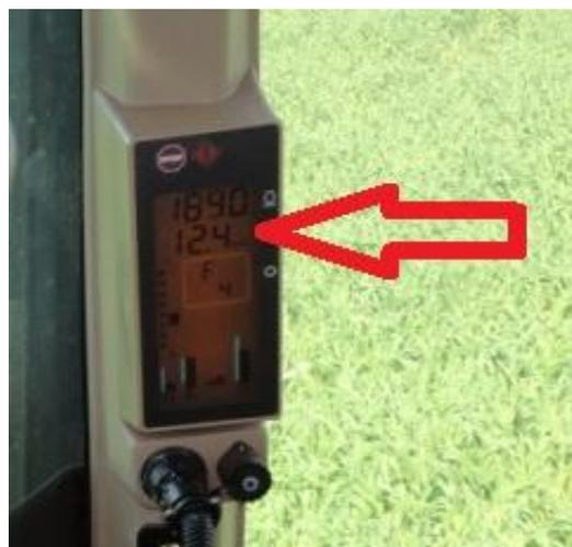
Figura 11 – Indicador da velocidade média durante o teste de simulação de pulverização em área experimental
