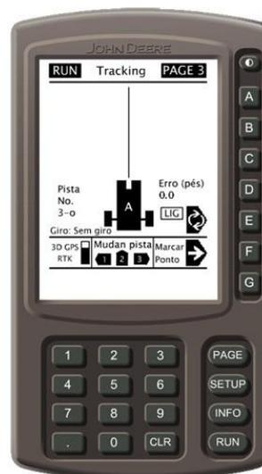
Figura 3 – Monitor virtual, simulando um percurso sobre uma linha planejada
