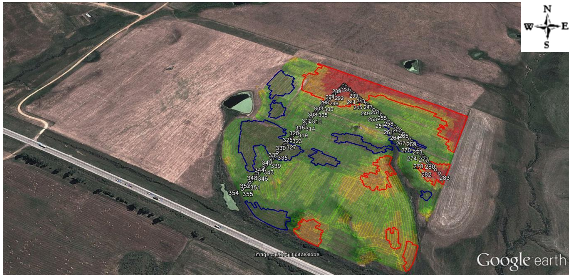
Figura 6 – Detalhe dos transectos com os 120 pontos de resistência a penetração.
