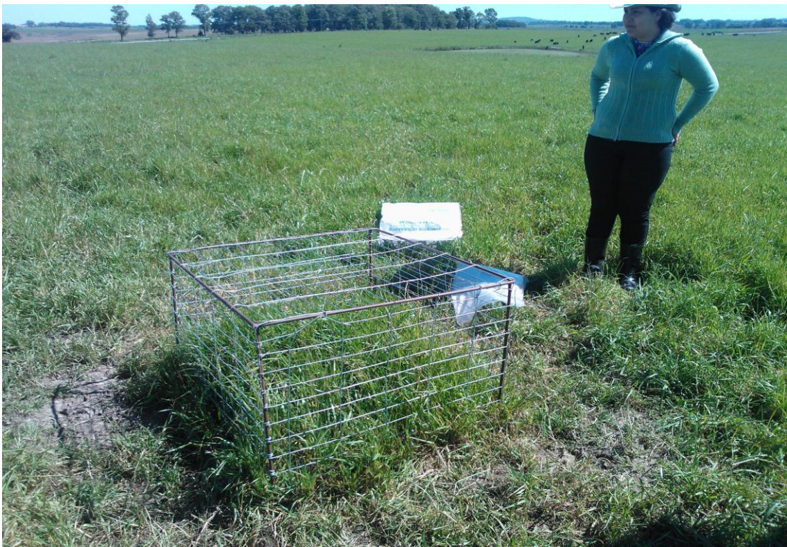
Figura 7 – Detalhe da gaiola de exclusão antes do corte da forragem.
