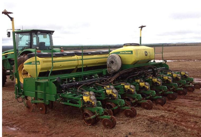
Figura 9 – Semeadora Adubadora 2117 CCS John Deere utilizada no experimento.
