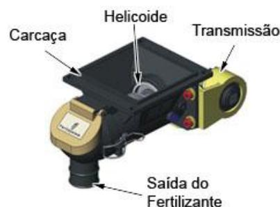
Figura 5 – Dosador de fertilizante do tipo helicoidal.
