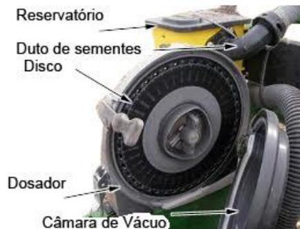
Figura 4 – Dosador de sementes pneumático.
