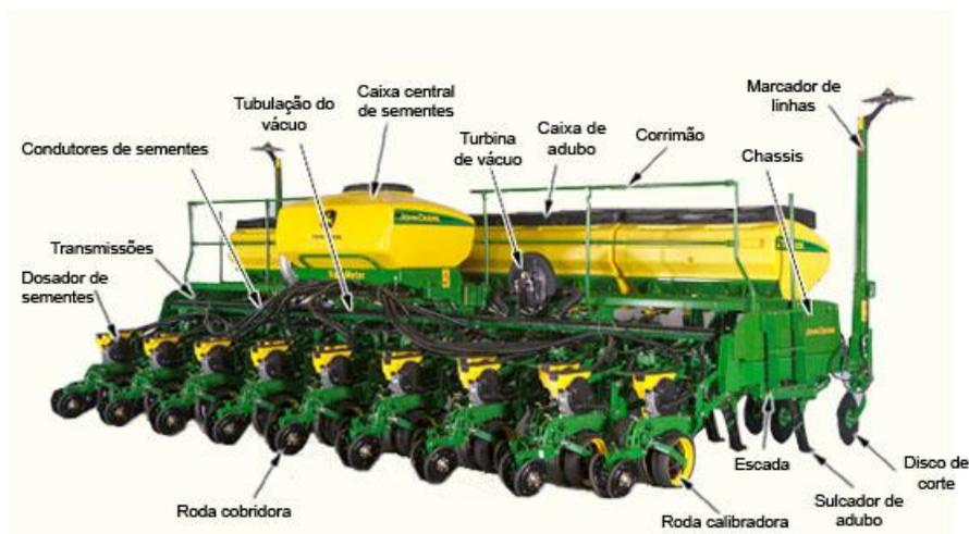
Figura 1 – Principais componentes de uma semeadora adubadora.
