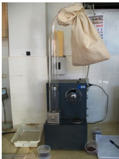
Figura 1 – Soprador de sementes forrageiras
