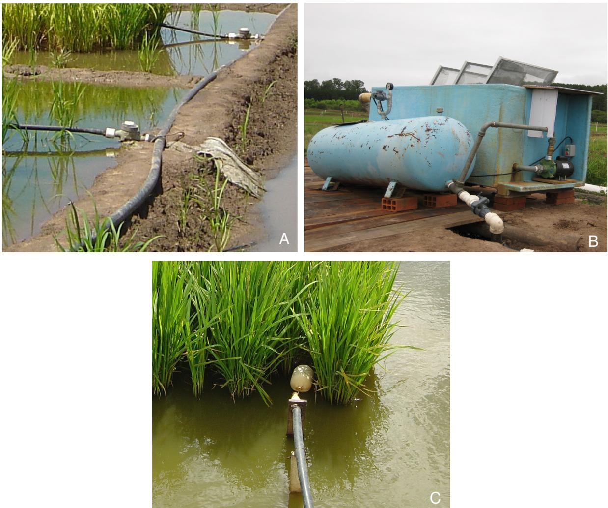
**Figura 15.** Vista dos componentes do sistema de irrigação, composta por hidrômetros (A), sistema de pressurização (B) e bóias (C), utilizados para a quantificação e pressurização do volume de água aplicado nas parcelas e regulagem da altura da lâmina de irrigação, respectivamente. Santa Maria, RS. 2009.
