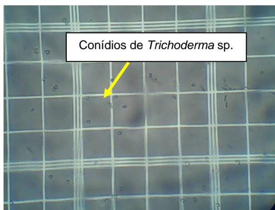
**Figura 2 – Hemacitômetro (ou Câmara de Neubauer) em microscópio ótico para contagem de conídios. Santa Maria, RS, 2009.**
