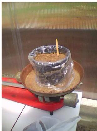
**Figura 7 – Pesagem dos vasos para aferição da capacidade de campo do solo. Santa Maria, RS, 2009.**
