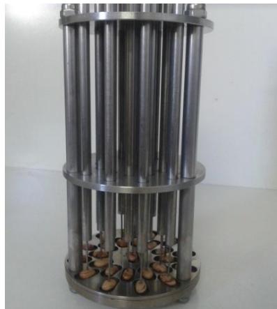
Figura 2 - Cozedor de Mattson usado para determinar o tempo de cozimento dos grãos.
