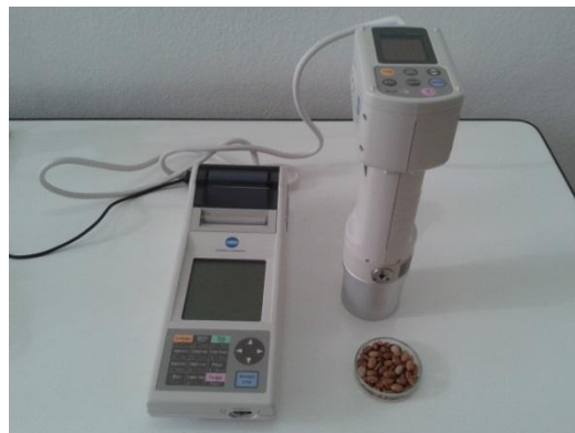
Figura 1 - Colorímetro modelo CR 410 usado para a determinação da coloração do tegumento dos grãos.
