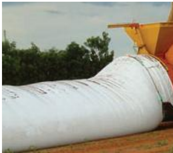
Figura 4 – Silo tipo ‘Bag’ usado para armazenar grãos de soja
