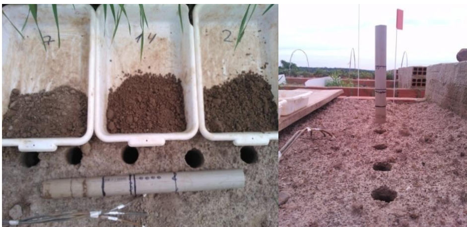
Figura 7 – Coleta de cinco sub-amostra para homogeneizar nas bandejas e fazer uma composta para análise, aos 7, 14 e 21 cm do perfil do solo.
