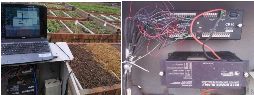
Figura 5 – Sistema de coleta e armazenamento dos dados sensores de temperaturas do solo.
