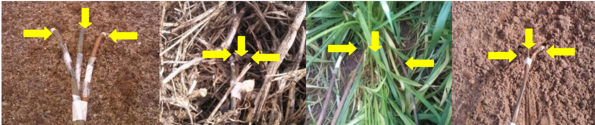
Figura 4 – Sensores de temperatura localizados nas profundidades de 7, 14 e 21 cm sobre os tratamentos alqueive sem revolvimento, resteva da soja, cultivo do trigo e alqueive com revolvimento.
