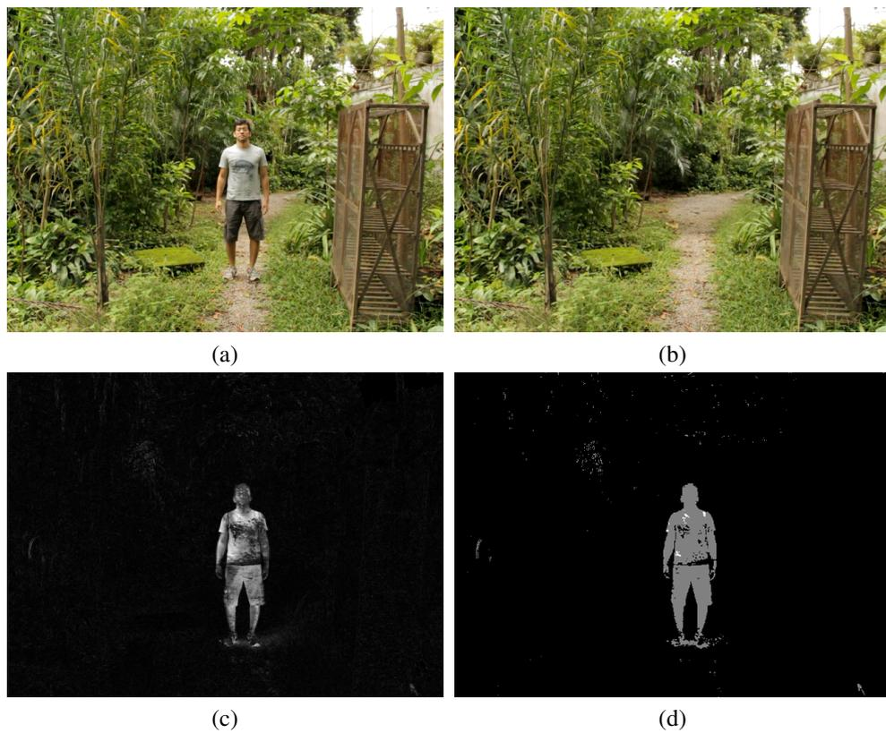
Figura 7.3: Demonstração do efeito de variações no fundo em imagens fotográficas. a) imagem de entrada. b) Fundo usado. c) mapa de distâncias calculado usando o espaço de cor LAB. d) Trimap resultante.
