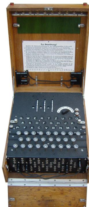
Figura 1: Máquina alemã de criptografia "Enigma"
