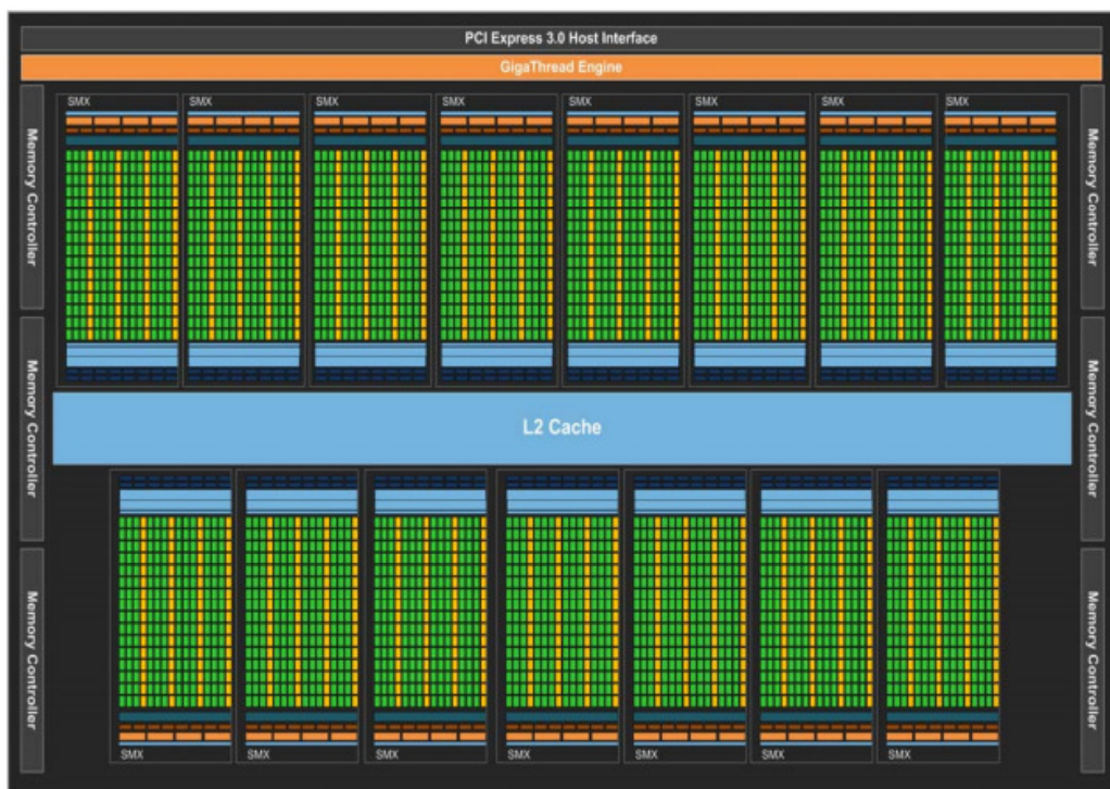
Figura 6 - Arquitetura de GPU fabricada pela NVIDIA – família Kepler Fonte: (NVIDIA, 2013).
