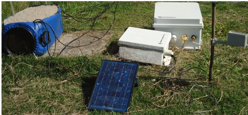
Figura 4.26: Painel solar para alimentação externa de energia.
