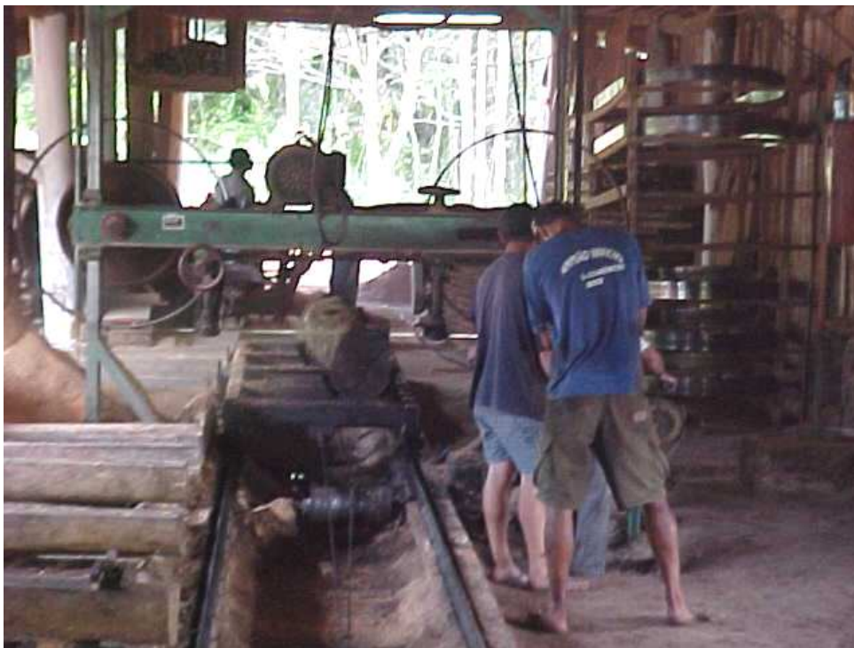
Figura 13 – Falta de EPI’s
