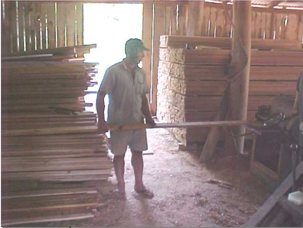
Figura 11 – Área de circulação obstruída
