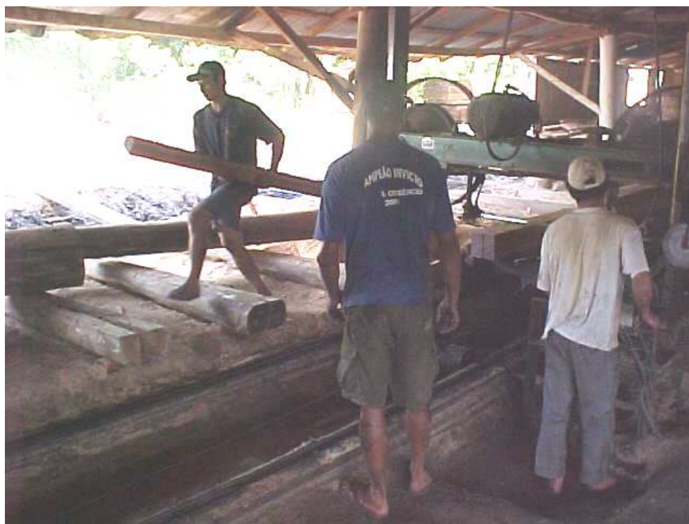
Figura 10 – Movimentação de materiais em local inadequado
