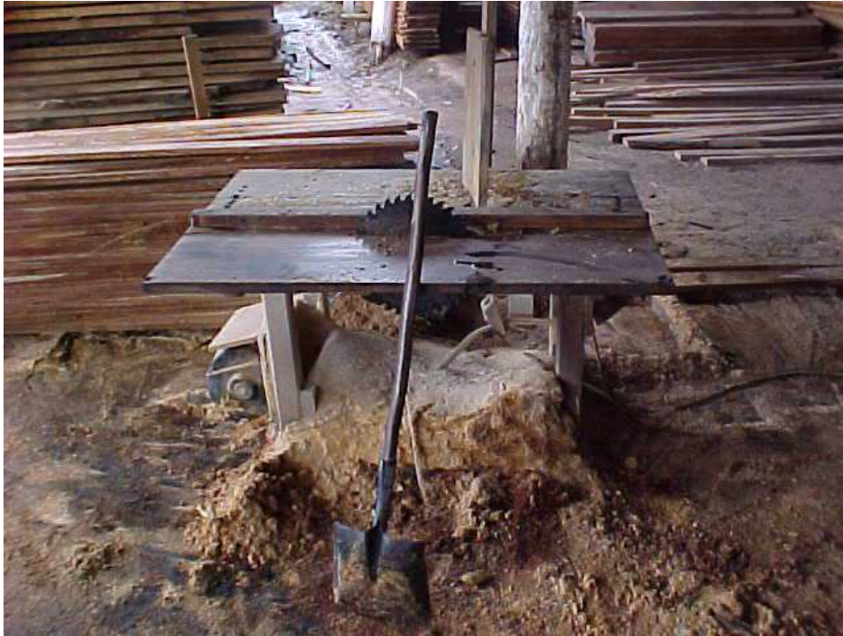
Figura 07 – Falta de proteção na serra circular
