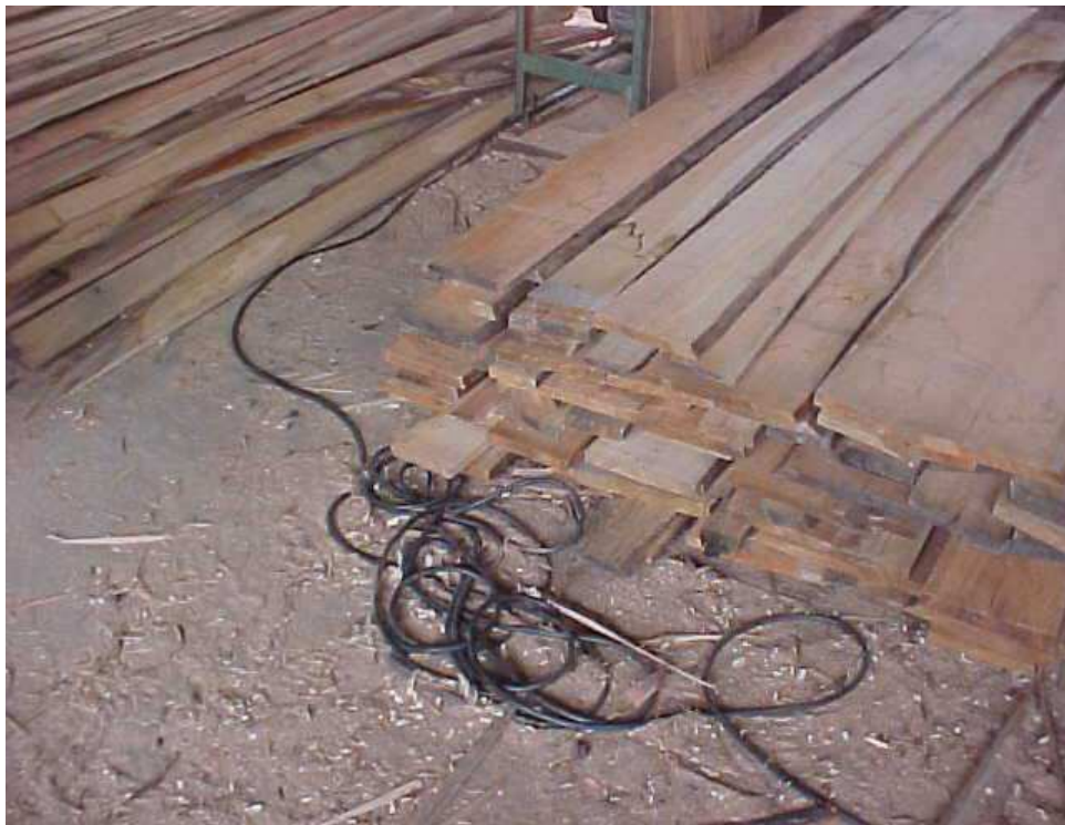
Figura 17 – Cabos elétricos em local de passagem
