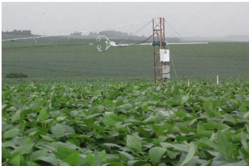
Figura 4. Torre micrometeorológica montada na cultura de soja em fase vegetativa.
