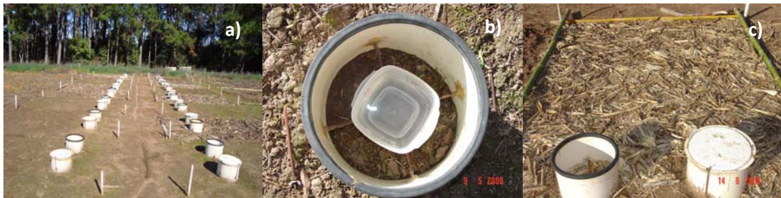
Figura 13 – a) visão geral do experimento; b) detalhe do sistema de coleta do CO 2 , mostrando o recipiente com NaOH no interior da câmara e c) duas câmaras de cada repetição de um dos tratamentos. Santa Maria, 2009. Denega, 2008.
