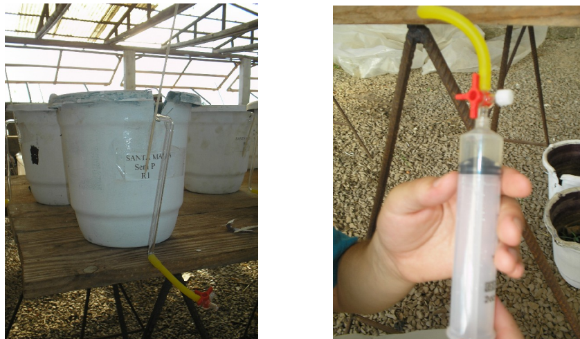
Figura 2 – Sistema de coleta implantado nos vasos e seringa de polietileno para coleta da solução.
