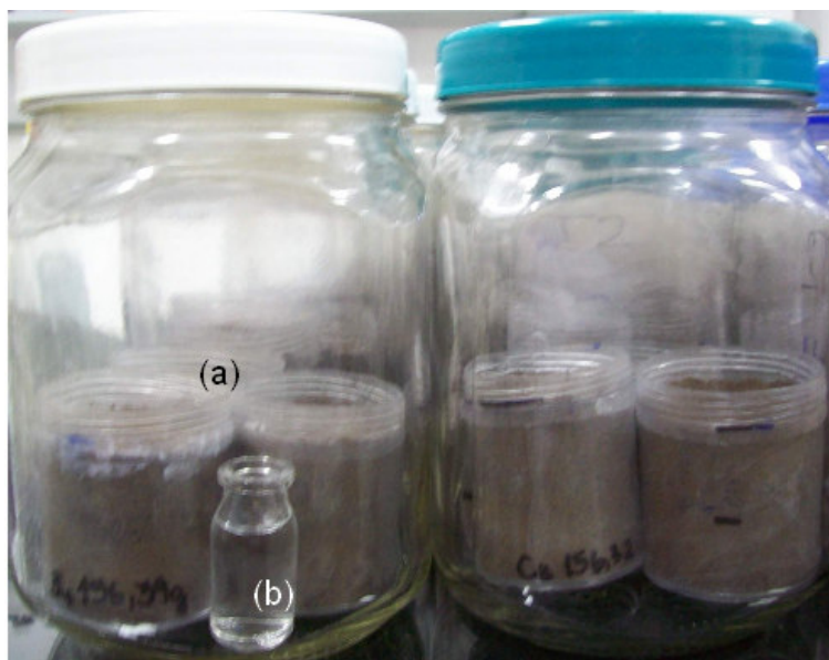
Figura 1.2 – Frascos de vidro contendo no seu interior três frascos de acrílico (a), com as repetições dos tratamentos e um frasco menor (b) com água para repor as perdas por evaporação.
