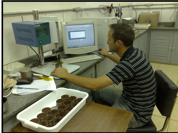
FIGURA 6 – Penetrômetro de bancada. Marca Marconi. Física do Solo/UFSM/RS. Foto: Kunz, 2009.
