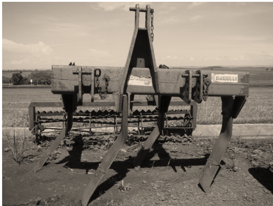
Figura 2 - Escarificador tipo Cruzador Carelli MAX, utilizado no sistema plantio direto escarificado a cada ano (SPDE1) e a cada três anos (SPDE3). Londrina, PR 2013.
