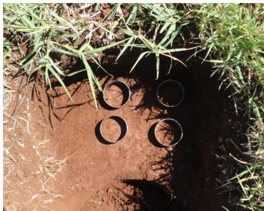
Figura 8 – Disposição dos anéis metálicos para coleta de solo.
