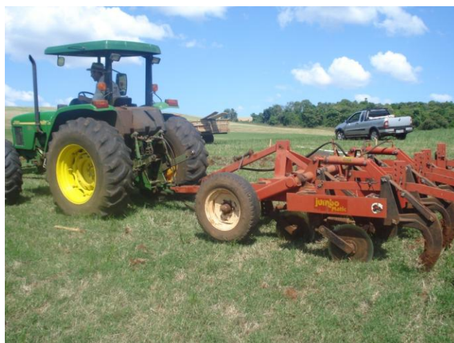
Figura 4 – Escarificador utilizado para o manejo do solo.
