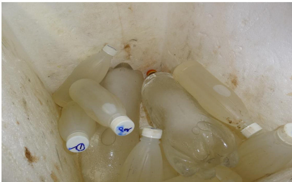
Figura 8. Amostras de água do fluxo natural, coletadas e armazenadas em caixa térmica, para posterior análise em laboratório.
