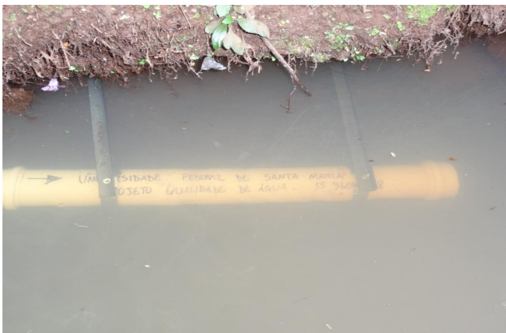
Figura 5. "Torpedo" para a coleta em tempo integral de sedimentos em suspensão instalado nos pontos de monitoramento.
