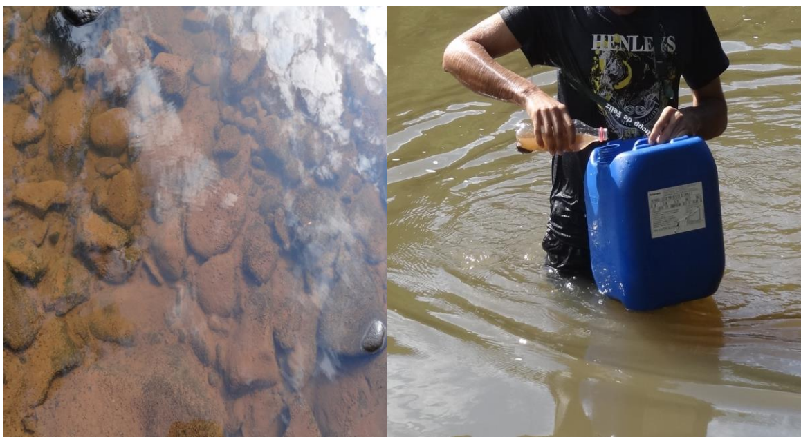
Figura 6. Coleta dos sedimentos de fundo com a utilização de uma garrafa “pet” plástica.
